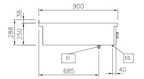
Electrical inlet (power) **Equipotential screw**
